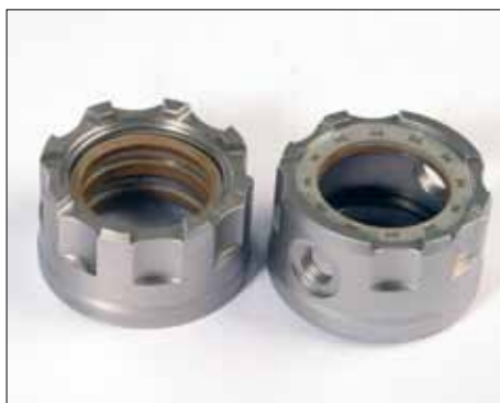
As duas versões de carcaça da vedação da bomba SPS 100: esquerda, sem sistema de lavagem fixo; direita, com sistema de lavagem fixo
