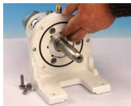
Anello distanziatore con il bordo smussato rivolto verso l'alto
