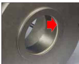
O-ring corpo pompa
