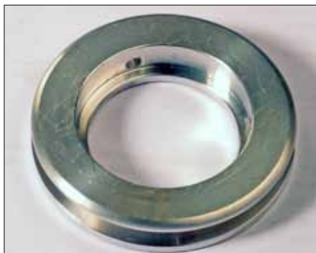
Anello distanziatore con il bordo smussato rivolto verso l'alto
