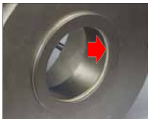
O-ring corpo pompa
