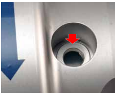
Sede guarnizione pompa maschiata
