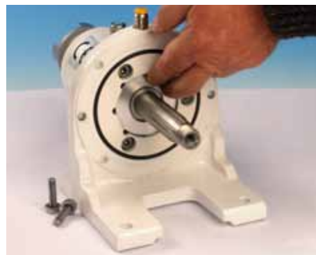
El anillo de separación con el borde redondeado hacia arriba
