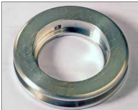
El anillo de separación con el borde redondeado hacia arriba
