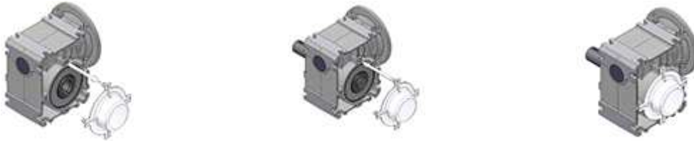
그림 16: 커버 캡 제거 및 조립 방법
