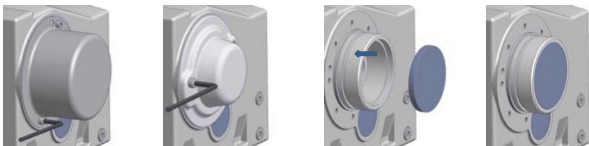
그림 15: 커버 옵션 SH, 옵션 H, 옵션 H66 조립 방법
