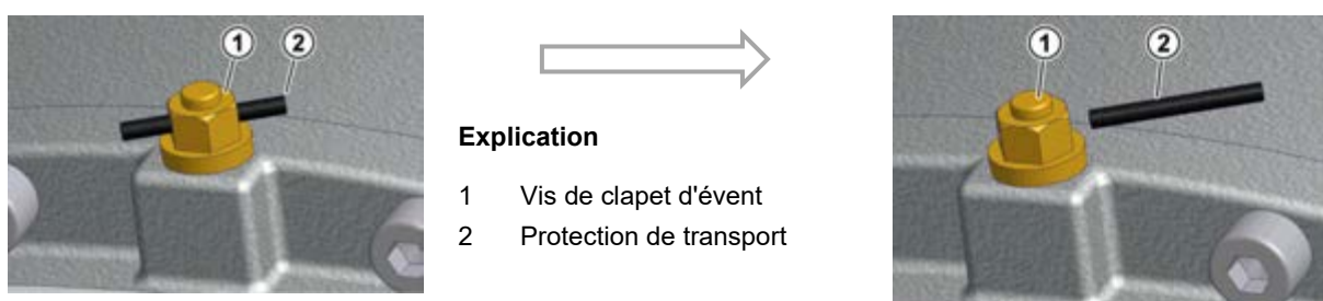
Figure 3: Activation de la vis du clapet d'évent
