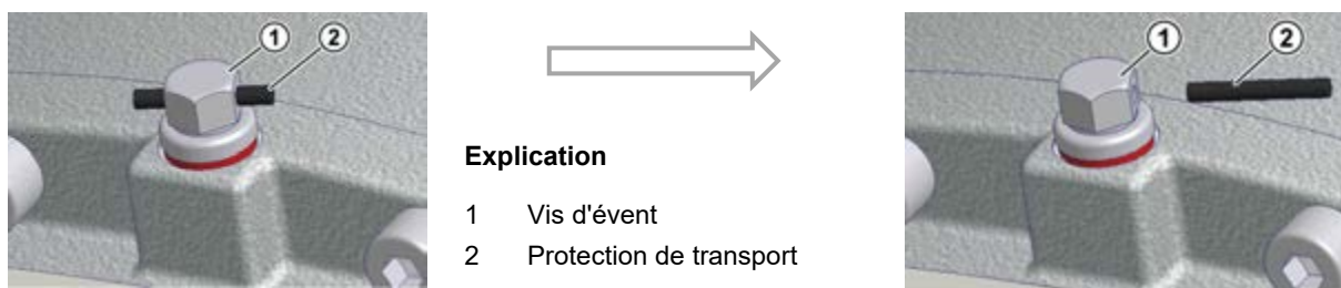
Figure 2: Activation de la vis d'évent
