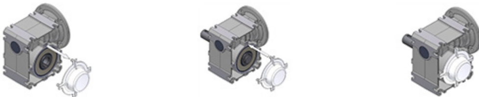
Afbeelding 16: demontage en montage van de afdekkap
