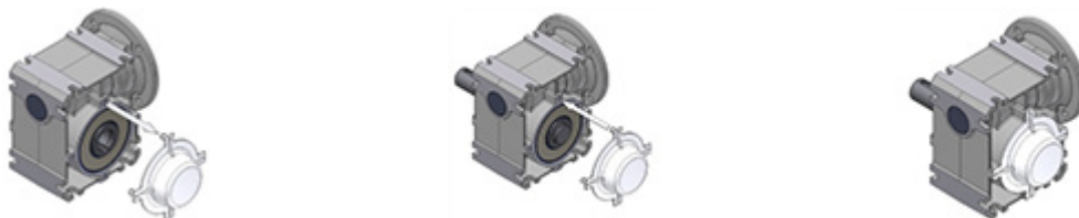
Illustration 16: Afmontering og montering af afdækningshætter
